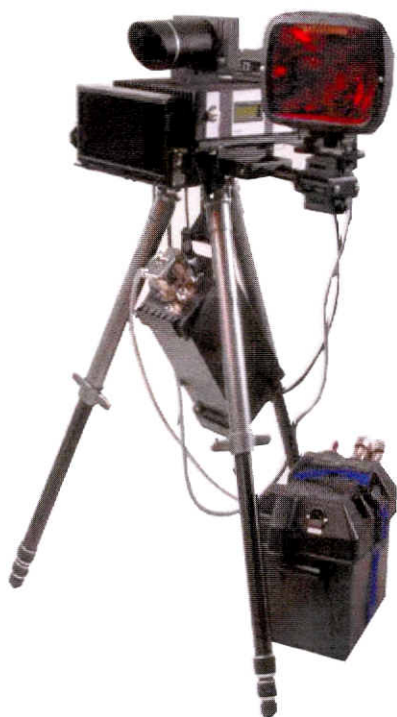
Rys. 6 Przyrząd o nazwie MultaRadar CM albo o nazwie MultaRadar CD w wersji przewoźnej na statywie
