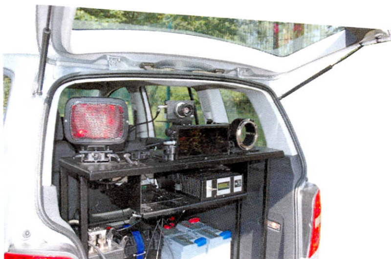
Rys. 13 Przyrząd o nazwie MultaRadar CM albo o nazwie MultaRadar CD w wersji przewoźnej w pojeździe stojącym na poboczu drogi
