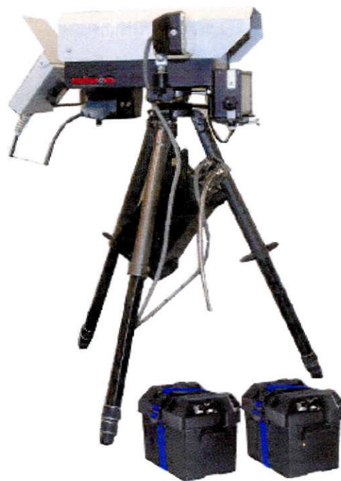
Rys. 7 Przyrząd o nazwie MultaRadar C w wersji przewoźnej w obudowie zewnętrznej na statywie
